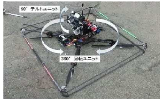
構造物点検調査ヘリシステム（SCIMUS：スキームス）
