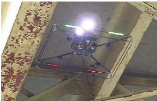
構造物点検調査ヘリシステム（SCIMUS：スキームス）
